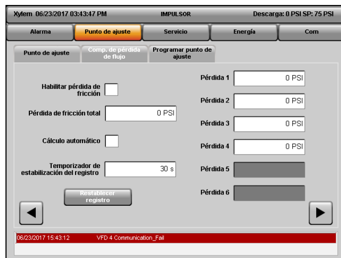
Figura 5.4.2: Ejemplo de trabajo de compensación de pérdida de flujo
