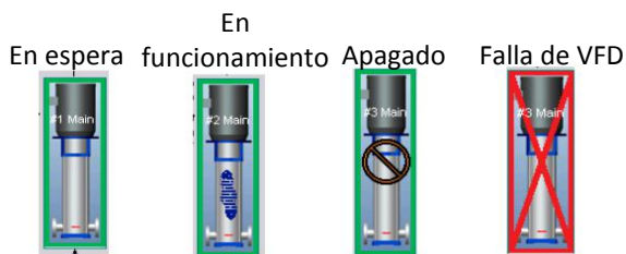
Figura 5.1.7. Estado de bomba
