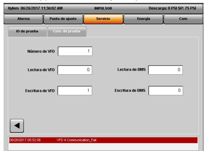
Figura 5.5.36: Comunicación de prueba (VFD y BMS)
