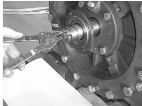
الشكل 27 : إزالة حلقة سند سطح الارتكاز ( فقط للهيكل من حجم 2 بوصة )
