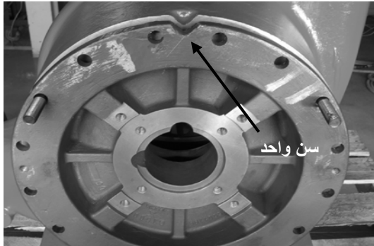
الشكل 39: تركيب صفيحة الغطاء باستخدام قضيب الإرشاد.
