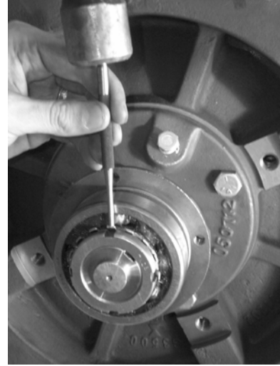
الشكل 50: تركيب السدادة الفلكية و صامولة التثبيت.
