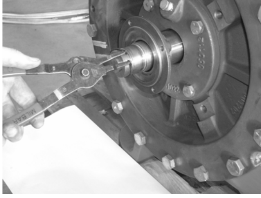
الشكل 49: تركيب حلقة سند لسطح الارتكاز ( فقط للمضخات ذات الهيكل من مقياس 2 بوصة ) 3. سخن سطح الارتكاز باستخدام سخان التنصيب.
