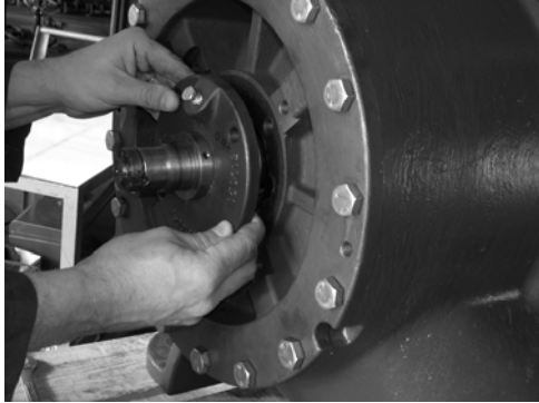
الشكل 28: إزالة تجميع السدادات و الغطاء.
