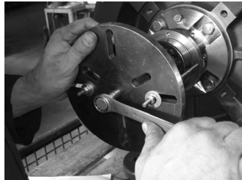
الشكل 26 : إزالة سطح الارتكاز بواسطة زمرة التثبيت الشاملة.
