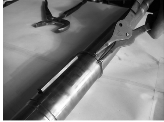
الشكل 36: تركيب حلقة تثبيت المحرض
