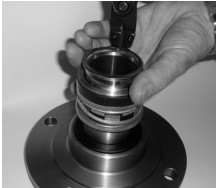
الشكل 29: إزالة السداد المحكم الميكانيكي و السدادة مع حلقة الضبط.
