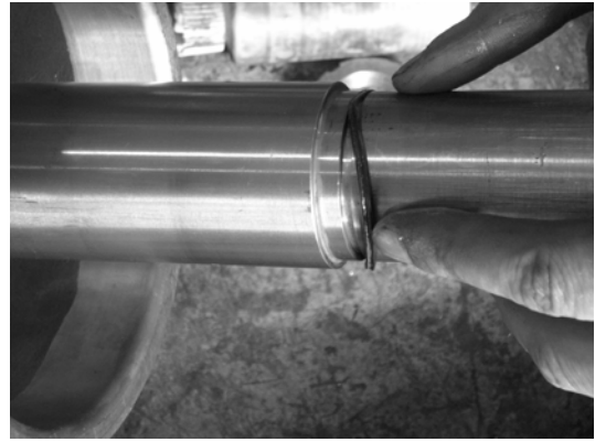
الشكل 37: تركيب حلقات التوسيع
