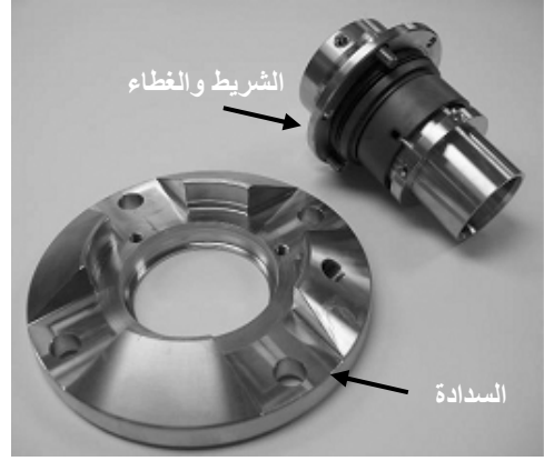
الشكل 33: خرطوش السدادة المحكمة وزمرة عدة الصيانة (الشريط و الغطاء)
