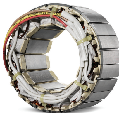
Der IE4 Motor des Concertor ist aufgrund der konzentrierten Statorwicklung kürzer und kompakter als ein konventioneller Motor.
