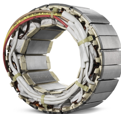
A Flygt Concertor IE4-es motorja az állórész koncentrikus tekercselésének köszönhetően rövidebb és kompaktabb a hagyományos motoroknál
