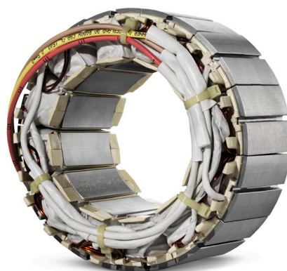
Il motore IE4 di Concertor è più corto e compatto dei motori tradizionali per mezzo dell'avvolgimento statorico concentrato.
