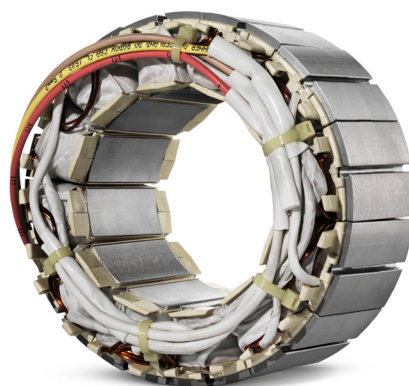
Concertors IE4-motor är kortare och mer kompakt än en konventionell motor tack vare konstruktionen med koncentrerad statorlindning.
