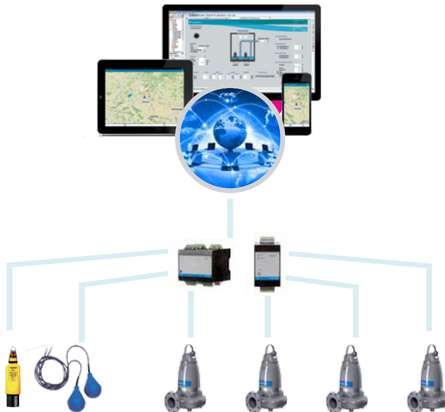
Darstellung der Vernetzung von Pumpe und Niveausensoren bis zur Ausgabeeinheit als MyConnect oder Desktopvisualisierung.
