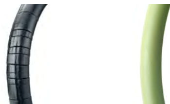
O-Ringe aus Nitril (links) und Viton nach einem Test bei 200° C.
