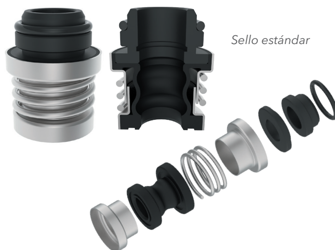
Sello estándar del eje de acoplamiento cerrado
