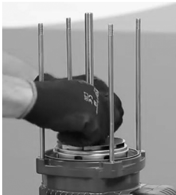
15. Retire el espaciador del impulsor.
