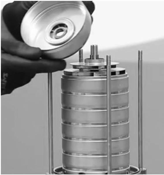
c) Déposer le roulement.
