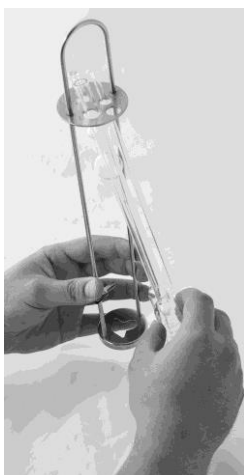
Abb. 4 Einführen bzw. Austauschen eines Viskosimeters mit Lichtschrankenabtastung
