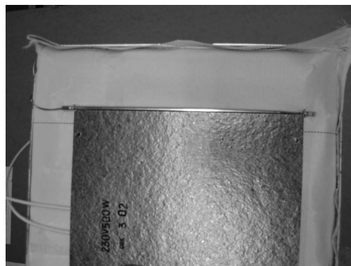
Positionierung des Kapillarrohrfühlers am Heizelement
