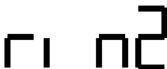
Fig. 6 Affichage dans le cas d'une sélection de deux cycles de rinçage.
