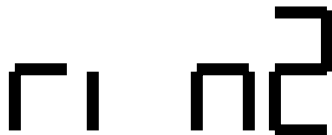
Abb. 6 Anzeige bei zwei eingestellten Spüldurchläufen.
