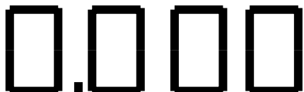
Fig. 11 Affichage du volume après la mise sous tension.
