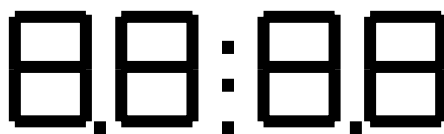
Fig. 7 Affichage LCD montre tous les segments.
