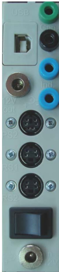
Abb. 11 Anschlüsse auf der Rückseite des Titrators TitroLine KF trace
