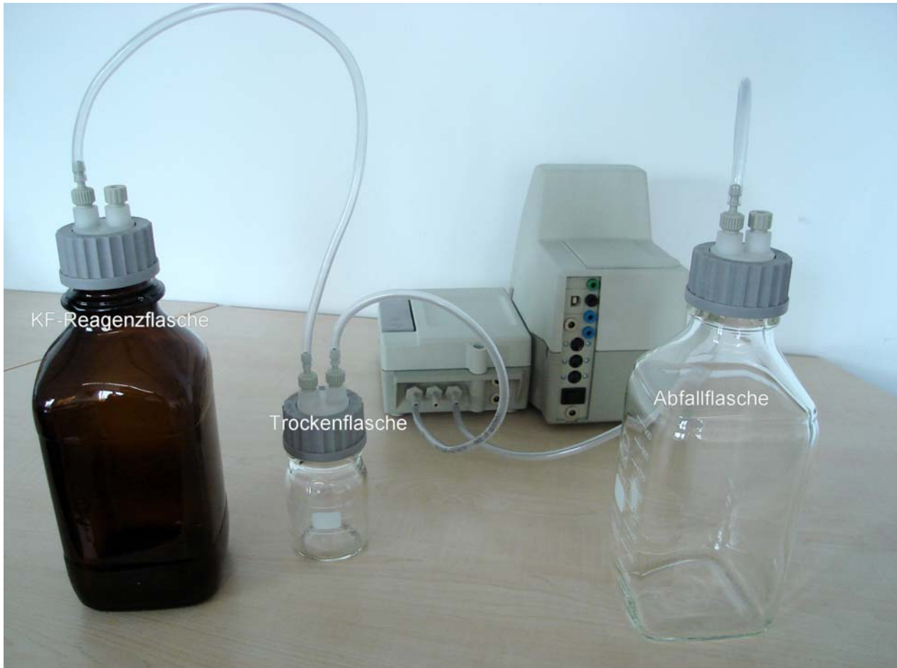
Abb. 12 Anschlüsse auf der Rückseite des Titrierstandes TM KF und des KF Trace
