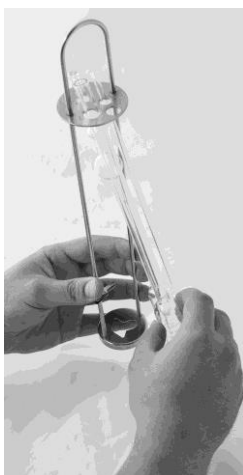
Abb. 4 Einführen bzw. Austauschen eines Viskosimeters mit Lichtschrankenabtastung
