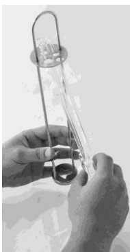
Fig. 4 Introduction ou remplacement d'un viscosimètre avec détection à barrières lumineuses dans un support de fixation
