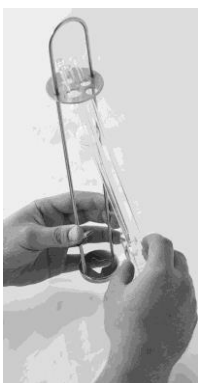
Fig. 4 Inserción o reemplazo de un viscosímetro con detección de barrera de luz
