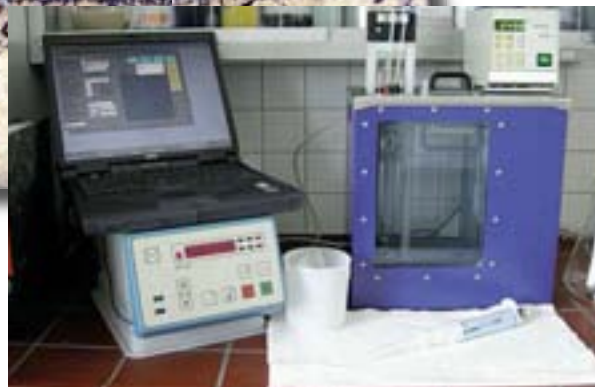
2 Messplatz am Zentrum für Bucherhaltung mit einem Viskositätsmessgerät AVS 370 und Durchsicht-Thermostat CT 53.
