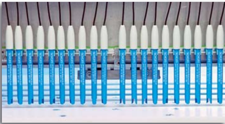
BlueLine-Elektroden in der Endkontrolle: Bei jedem einzelnen Exemplar werden Nullpunkt, Steilheit und Einstellzeit geprüft.
