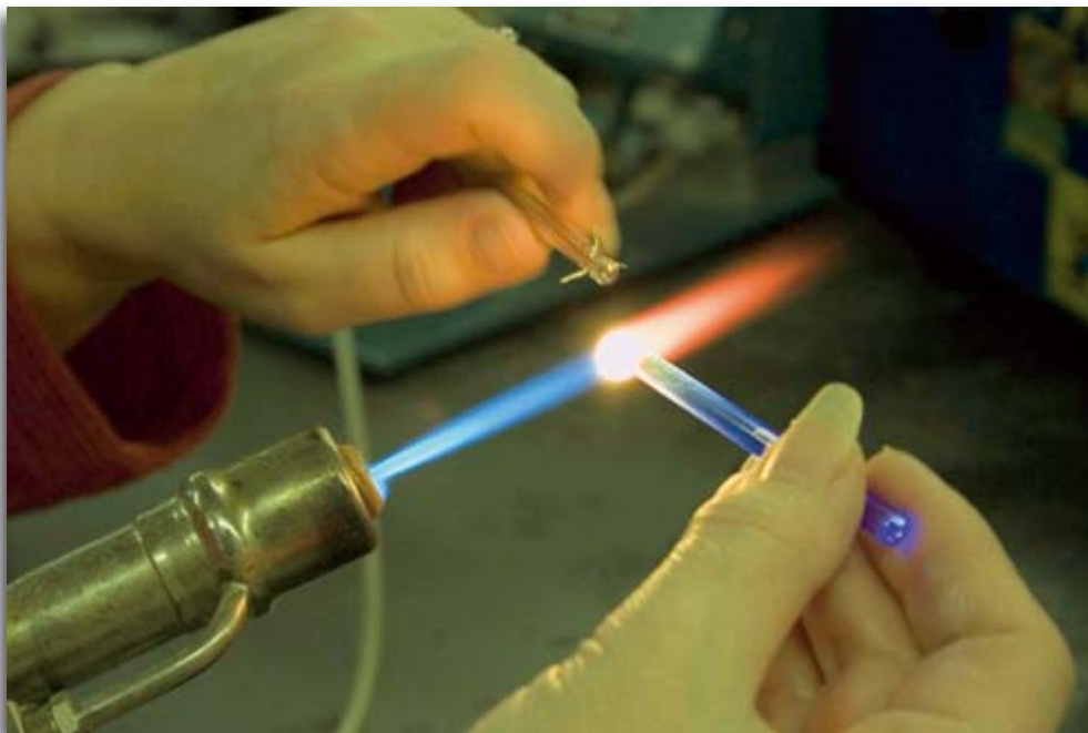
Bei der Fertigung von Elektroden ist glasbläserisches Können auch heute noch unverzichtbar.
