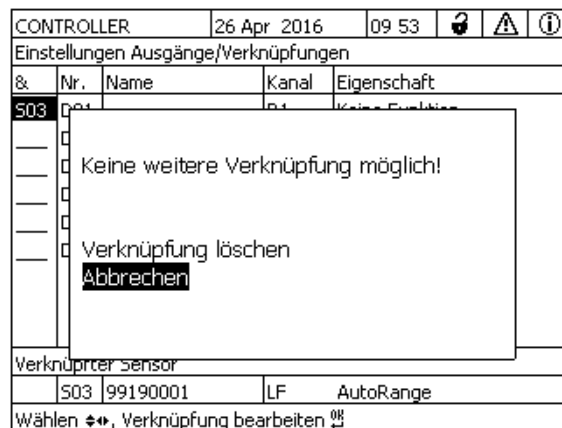
Bild 7-14 Einstellungen Ausgänge/Verknüpfungen: Verknüpfung löschen
