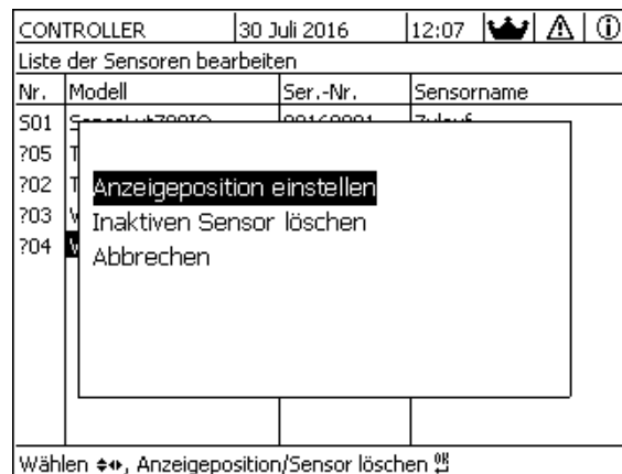
Bild 5-8 Liste der Sensoren bearbeiten -> Inaktiven Sensor löschen
