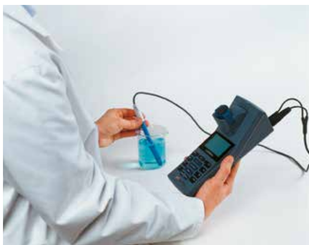
Mesure de pH avec le Photoflex pH ou Turb
