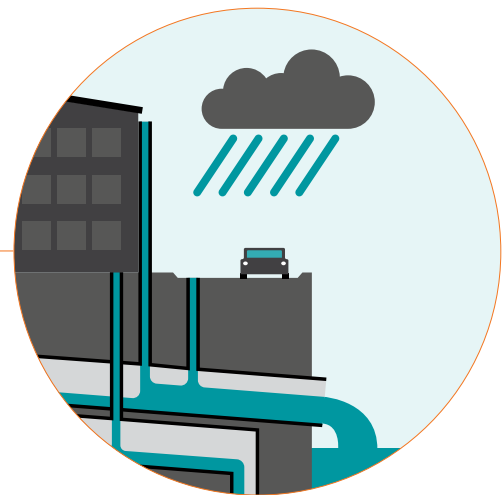
Separate Sewer Overflow (SSO)
