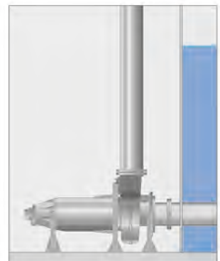
CZ - Horizontale, stationäre Trocken- oder Inline-Aufstellung mit Flanschanschlüssen für Saug- und Druckleitung.
