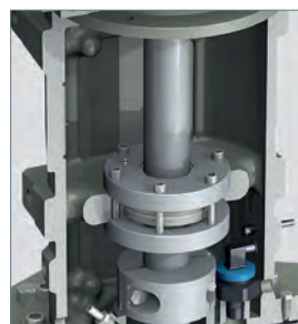
Robustes gusseisernes Lagergehäuse
