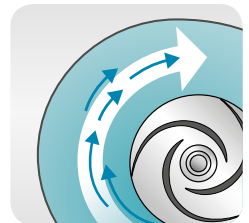
Flygt-Laufräder halten die Feststoffe mit der Strömung in Bewegung.
