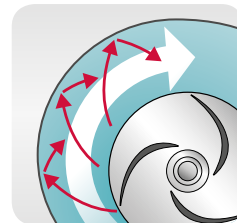
Gewöhnliche Laufräder schlagen die Feststoffe in die Spirale.
