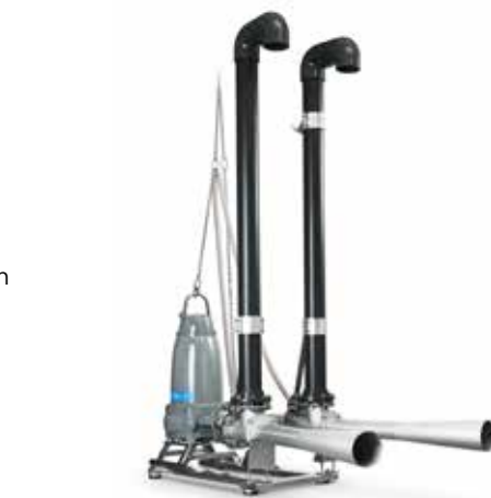
Der Flygt Strahlbelüfter besteht aus Luftansaugrohren, einer N-Pumpe, Ejektorgehäusen und Ejektoren.
