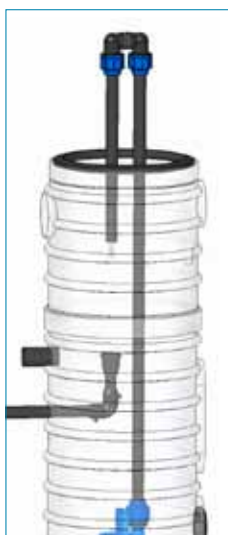
Teleskopiskt lock av polyeten (dubbelt låsbart) eller av gjutjärn.
