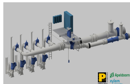
Overzicht van de huidige situatie, na renovatie gemaal Anklaar te Apeldoorn.
