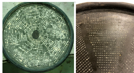
Zichtbare verstopping van de membranen
