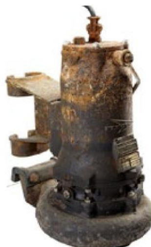
De effecten van algemene corrosie op een afvalwaterpomp die nog steeds werkt na 50 jaar van gebruik.
