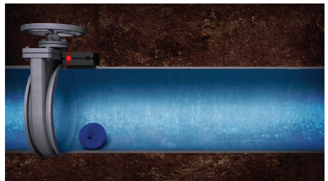
Einsatz des SmartBalls in einer Rohrleitung.
